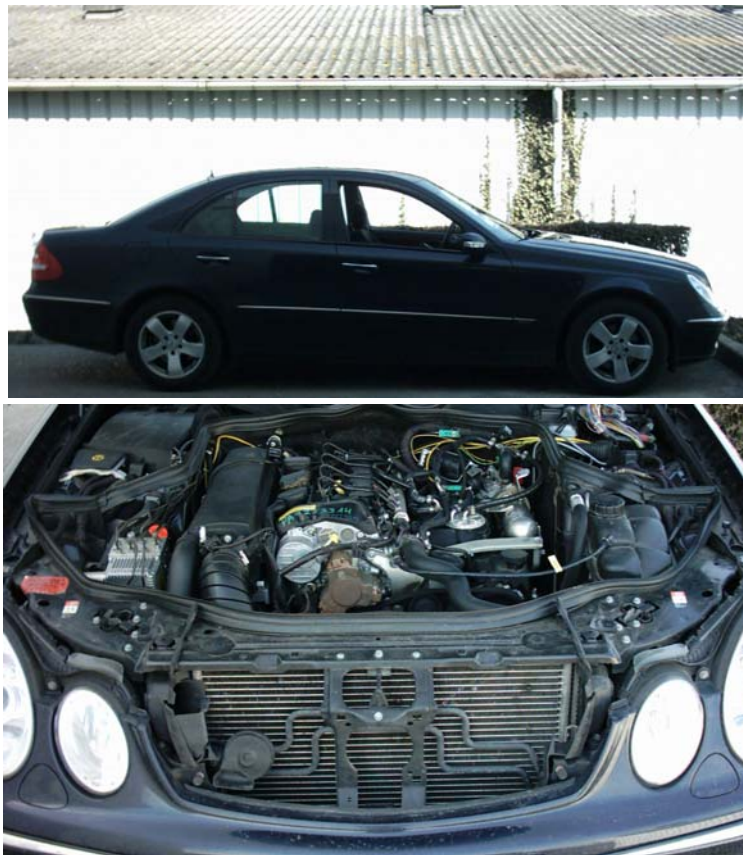
Figure 3.1 – Le véhicule de recherche : une Mercedes 220 E-class CDI, moteur diesel OM646 2.2 litres 168 hp (avec des capteurs additionnels).
