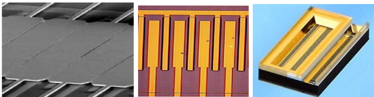
Figure III-4 : Image d'une partie du composant: structure miroir (gauche), implantation des électrodes (milieu), et image globale de la barrette de 40 miroirs (droite)
