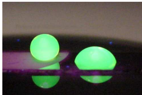
Figure I.1 : Illustration de l'effet Lotus par nanostructuration de la surface d'un wafer de Si
