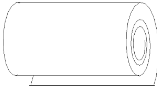
Figure I.2 : Représentation schématique d'un nanotube inorganique formé d'un seul feuillet enroulé sur lui-même, comme un papier de cigarette ou un parchemin
