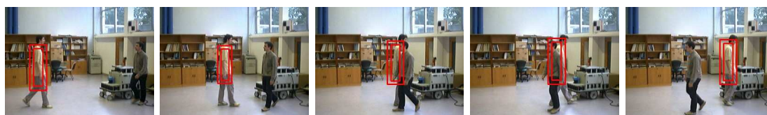
FIG. 4.36 – Exemple de réalisation sur une séquence incluant le croisement de deux personnes pour la stratégie HIERARC (modalité #3)
