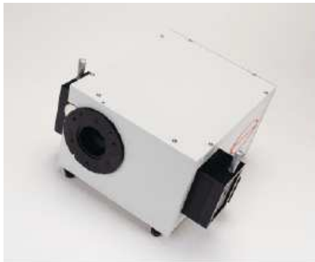
Fig. 2.3 Photographie du spectromètre SpectraPro SP-2360-P utilisé pour nos mesures de photoluminescence.
