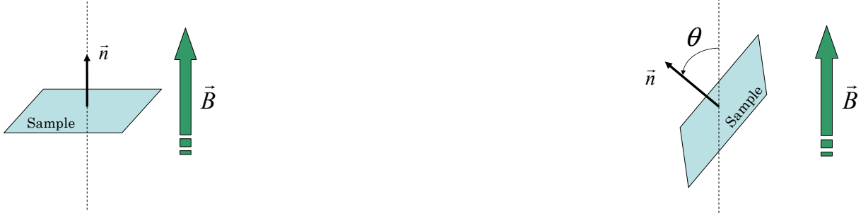
Fig. 4.17 Exemples de configurations, ici normale et inclinée, de l'échantillon par rapport au champ magnétique extérieur appliqué.
