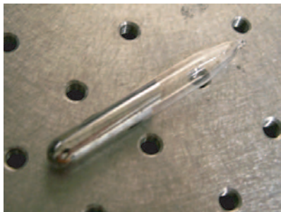
FIG. 1 – Cellule contenant quelques grammes de Rubidium. De consistance molle, d'aspect gris-blanc, ce métal est conservé ainsi à l'abri de l'humidité en raison de sa forte réactivité.
