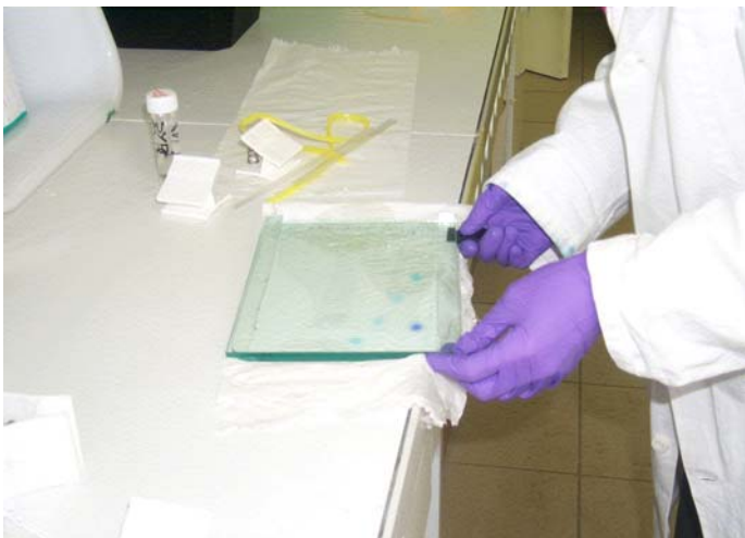
3 A et B : Décollage des deux plaques afin de récupérer le gel contenu à l'intérieur de ce sandwich en fin de migration.
