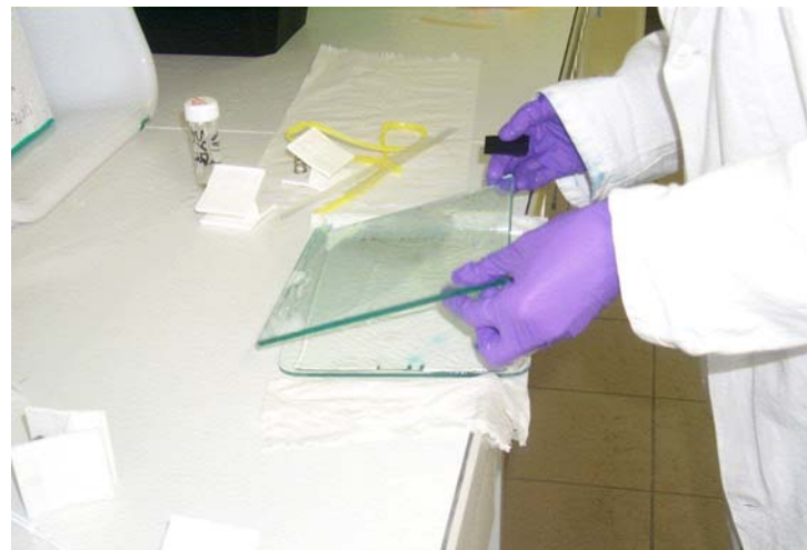
3 A et B : Décollage des deux plaques afin de récupérer le gel contenu à l'intérieur de ce sandwich en fin de migration.
