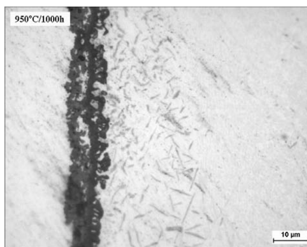
Figure 4.9: Micrographie optique de la section de l'échantillon oxydé 1000h à 950°C. On peut voir le film dense d'alumine à l'interface entre la couche externe et la zone riche en nitrure de titane. Etude du BAM (Pfennig, 2005).
