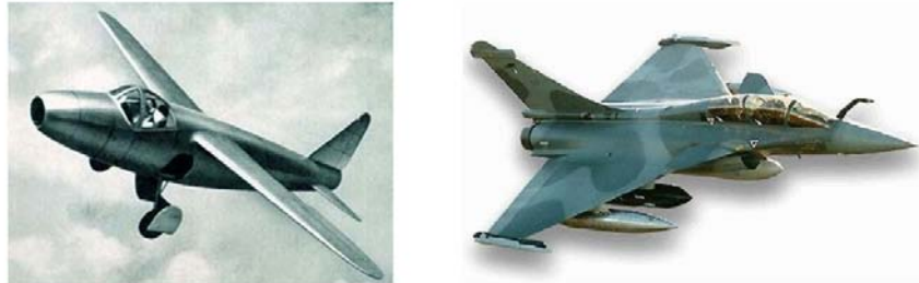
Figure 1: A gauche, le premier avion à turboréacteur : le Heinkel He 178. A droite, soixante ans plus tard, le Rafale de Dassault Aviation, équipé du turboréacteur M88-2.
