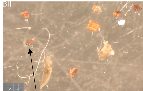
Figure A.34.b – Inclusions après extraction du matériau BII
