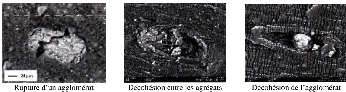
Figure B.94 – Endommagement rencontré dans le SBR chargé de silice
