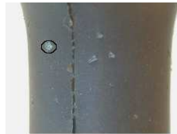
BI en traction état déformé (L = 22,5)
