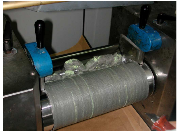
Figure I.2 – Le mélangeur externe à cylindres tournants
