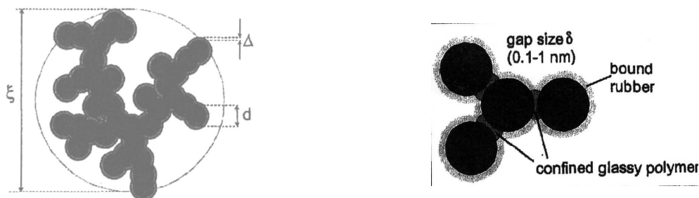
Figure B.1 – Schéma illustrant la présence du polymère à mobilité réduite 'polymère lié' responsable de la rigidité du réseau (Si-PI-Si) [Kluppel2004]
