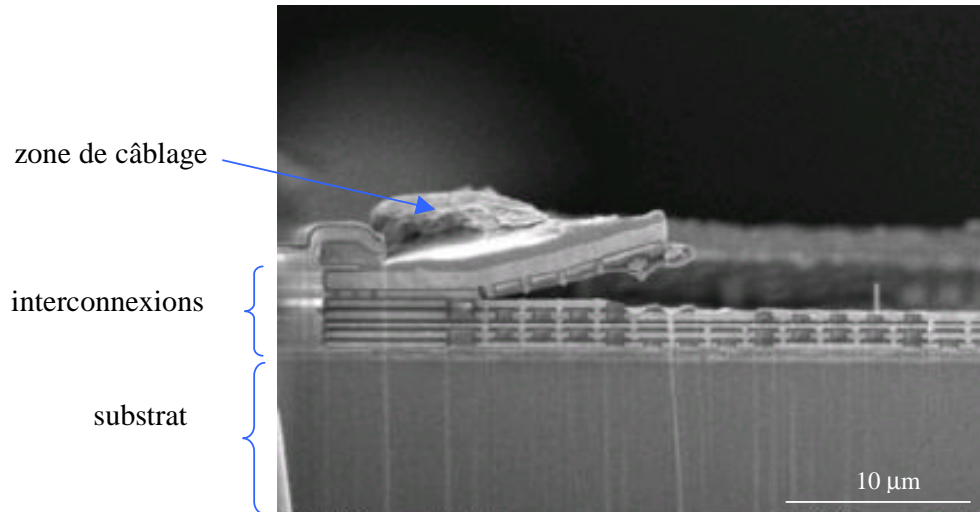
Figure I.14 : Image de délamination observées, après un essai d'assemblage, aux interfaces entre le cuivre et la barrière diélectrique (au niveau du métal 4) et entre le diélectrique « low-k » et la barrière diélectrique (au niveau du métal 5) [Crolles2 Alliance]
