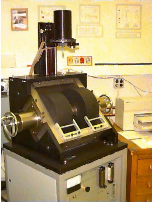
Figure III.26: Exemple de Micro VSM (Princeton Measurements Corporation) permet de mesurer l'aimantation en fonction du champ appliqué sur une large gamme de champ ( \pm 1T ).
