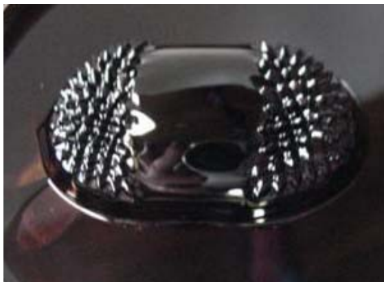
Figure 2.1. : Ferrofluide recouvrant un barreau aimanté. On peut voir l'intensité du champ magnétique au bord (pics) et un gradient au centre.
