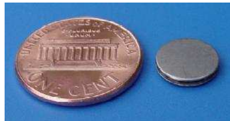
Figure I-7 : Générateur thermo life devant une pièce de monnaie [Stark2006].
