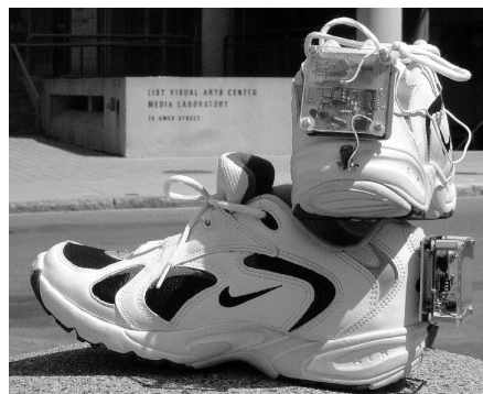
Figure I-22 : Un émetteur RFID qui utilise l'énergie de la marche [Shenck2001].
