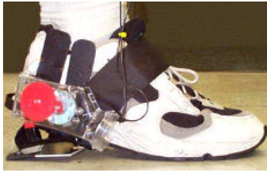
Figure I-10 : Un générateur électromagnétique monté sur la chaussure [Kymissis1998].
