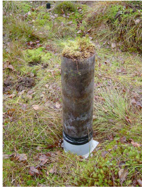
Figure 15 : Conditionnement de la carotte dans un tube PVC pour le transport
