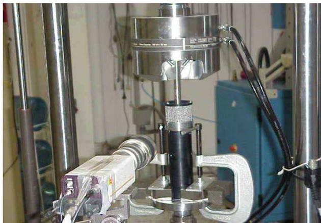
FIGURE 3.18: Montage quasi-statique de perforation.
