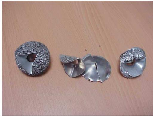
FIGURE 3.37: Photographie des sandwichs perforés en quasi-statique. Sandwich à base mousse Alporas( gauche), sphères creuses (milieu) et nid d'abeille (droite).
