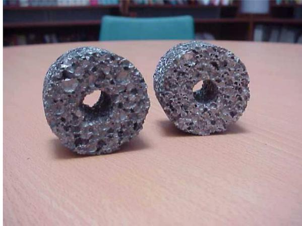
FIGURE 3.31: Photographie des mousses perforées en quasi-statique.
