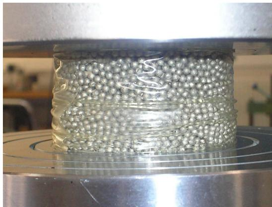
FIGURE 2.15: *Photographie d'essai de confinement de sphères creuses.*
