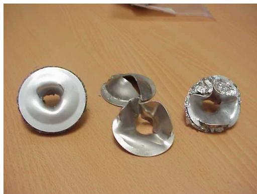
FIGURE 3.38: Photographie des sandwichs perforés en dynamique. Sandwich à base mousse Alporas (gauche), sphères creuses (milieu) et nid d'abeille (droite).
