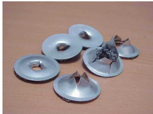
FIGURE 3.27: Photographies de post-perforation dynamique de la plaque incidente (les 3 peaux à gauche) et de plaque secondaire (les 3 peaux à droite).
