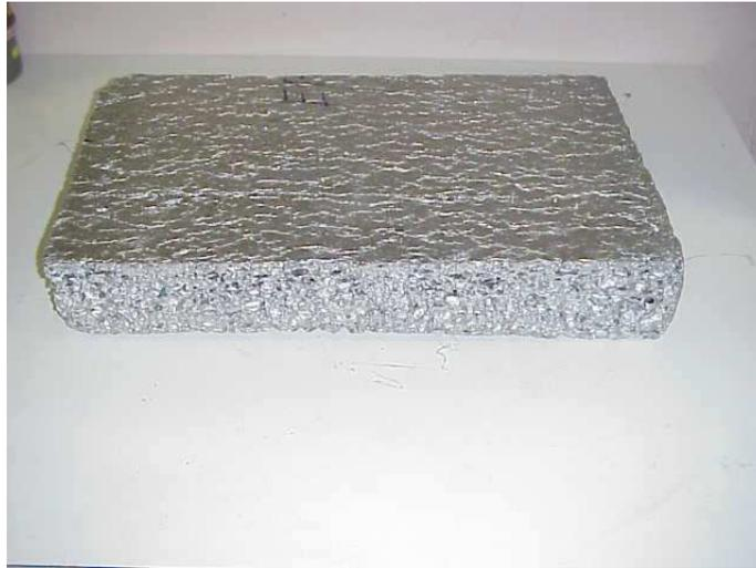
FIGURE 1.3: Photographie d'un bloc de mousse Cymat
