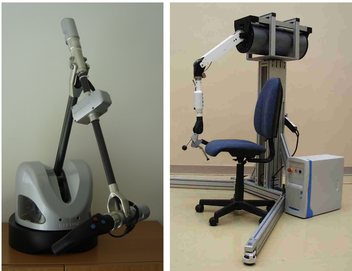
Figure 1. A gauche, Virtuose 6D35-45 et à droite, Virtuose 6D40-40, développés par la société HAPTION.
