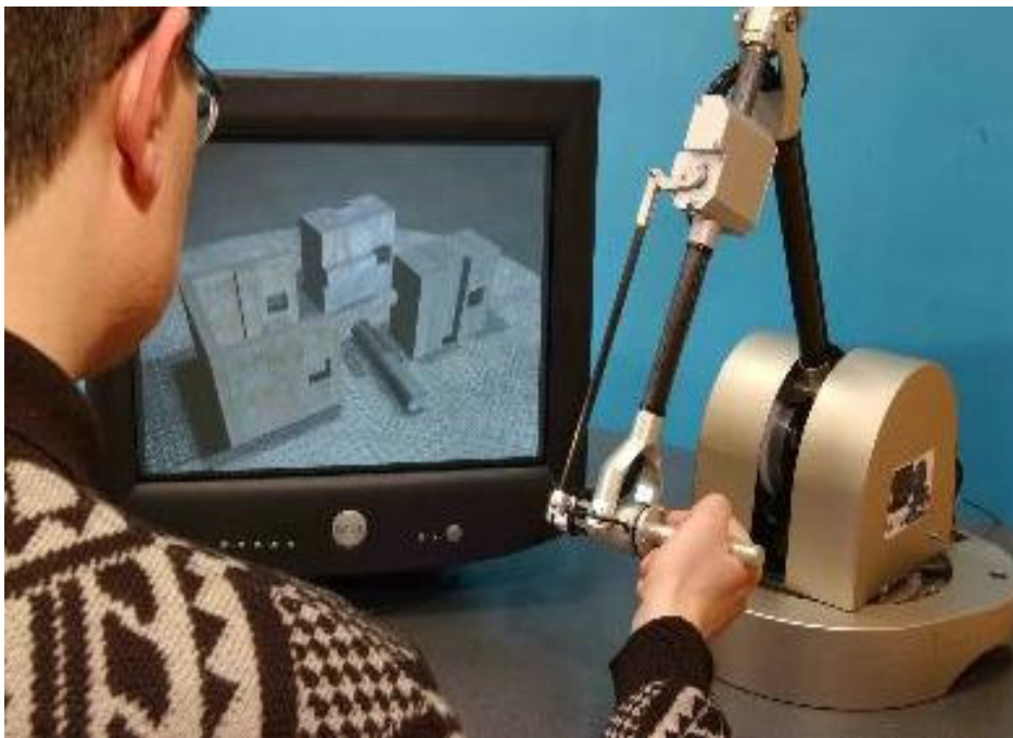
Figure I.1. Exemple d'interface haptique : opérateur, structure mécanique articulée, électronique embarquée et réalité virtuelle.
