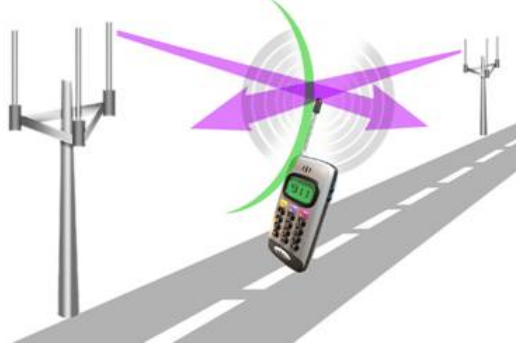
FIG. 1.20: Principe de la localisation AOA
