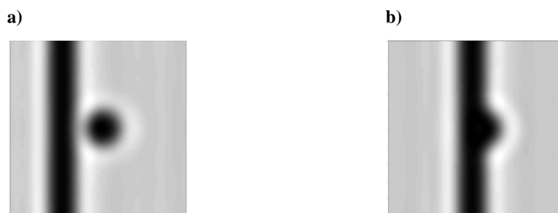
Figure 5.16 – Simulation de l'influence d'un défaut sphérique sur une ligne d'absorbeur (d'après [104]) ; a) Cas d'un défaut à proximité d'une ligne d'absorbeur avec une distance suffisante pour ne pas influencer la taille de ligne ; b) cas d'un défaut assez proche d'une ligne d'absorbeur et qui entraîne une modification locale de la taille du CD
