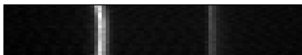
Figure 7.6 – Image ( 50\ \mu\text{m} \times 10\ \mu\text{m} ) d'un défaut linéique de 20\ \mu\text{m} de largeur et 20\ \text{nm} de hauteur. L'imagerie sur ce défaut engendre un contraste différent entre les bords gauche et droit d'un même défaut
