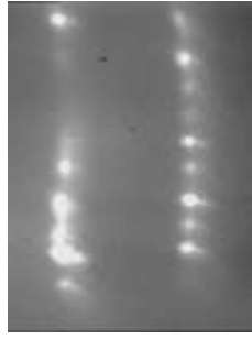
Figure 5.9 : Champ proche expérimental à la sortie d'une cellule d'éthanol pur d'1 cm de long après passage du faisceau par une fente.
