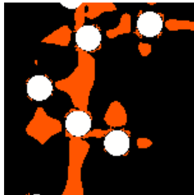
FIG. 7.4 – Amas de matière (en rouge) soumis à une déformation en cisaillement simple dans un milieu plastique aléatoire (avec pores en forme de disques de taille supérieure au pixel). Tous les amas ne sont pas joints aux pores (calcul avec fonction de Green “discrète”). Les pores sont en blanc, les zones de la matrice déformées élastiquement en noir. Voir texte p. 280.
