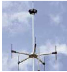
FIG. 1.4 – Réseau circulaire de 5 dipôles
