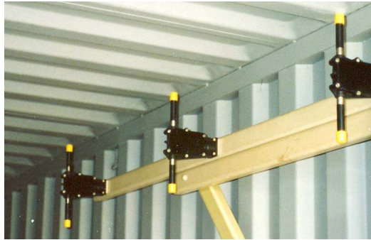
FIG. 1.5 – Réseau linéaire de 3 dipôles
