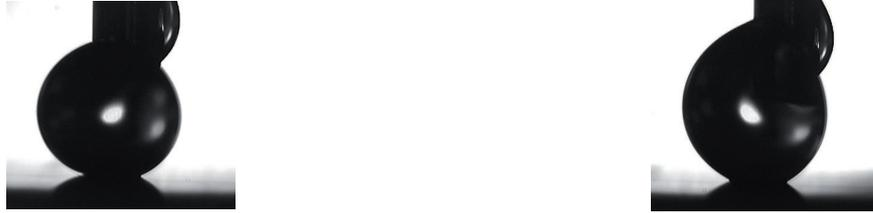
**FIG. II.3 :** Angles de contacts sur une surface microstructurée silanisée à l'OTS, pour une goutte de la solution aqueuse de glycérol utilisée dans les expériences de nanorhéologie. A gauche : angle d'avancée  $\theta_a = 155^\circ$ . A droite : angle de recul  $\theta_r = 144^\circ$ .
