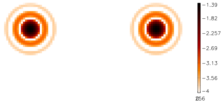
FIG. 14.8 – Illustration de la correction obtenue en simulation, avec intégrateur optimisé ou commande optimale, en terme de FEP. L'échelle est logarithmique, en intensité normalisée à 1.
