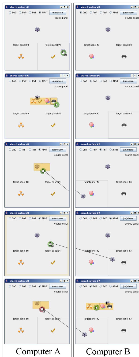
Fig. V.7: (De haut en bas) (a) drag-and-drop (b) push-and-pop (c) push-and-throw (d) push-and-throw accéléré (e) deux manipulations simultanées : un push-and-throw de A vers B et un push-and-pop de B vers A.
