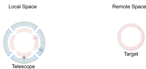
Fig. A.2: Le système frisbee contient un télescope et une cible. En interagissant à l'intérieur du télescope, l'utilisateur interagit avec la cible [Khan et al., 2004].
