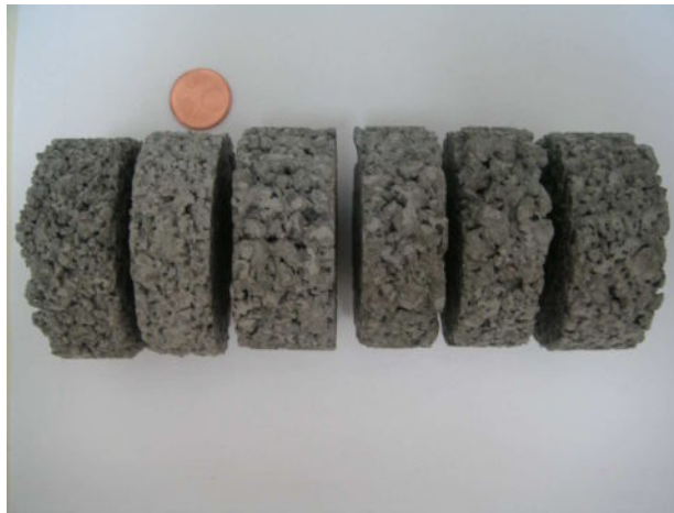
Figure 5.10 – Découpe de l'échantillon en 6 tronçons cylindriques
