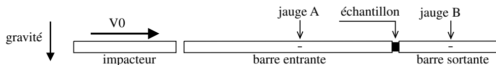
Figure M.1 – Représentation schématique d'un dispositif SHPB
