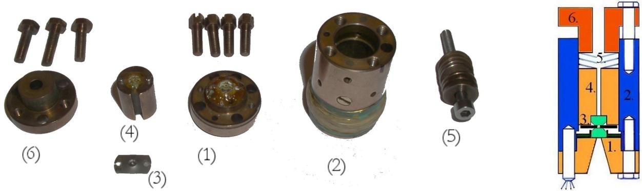
**FIG. 2.6 :** Photo d'une cellule pression typique à enclume diamant démontée, juxtaposée à son plan vu de coupe (d'après [THOMASSIN, 2000]). (1) représente le diamant inférieur sur lequel vient se fixer le socle (2); le joint (3) est alors posé sur le diamant mobile (4) puis amené dans la cellule. Des rondelles (5) permettent d'ajuster le piston et le tout est fermé et vissé grâce à la pièce (6). Les dimensions typiques de la cellule sont 2 cm de diamètre par 4 cm de haut .
