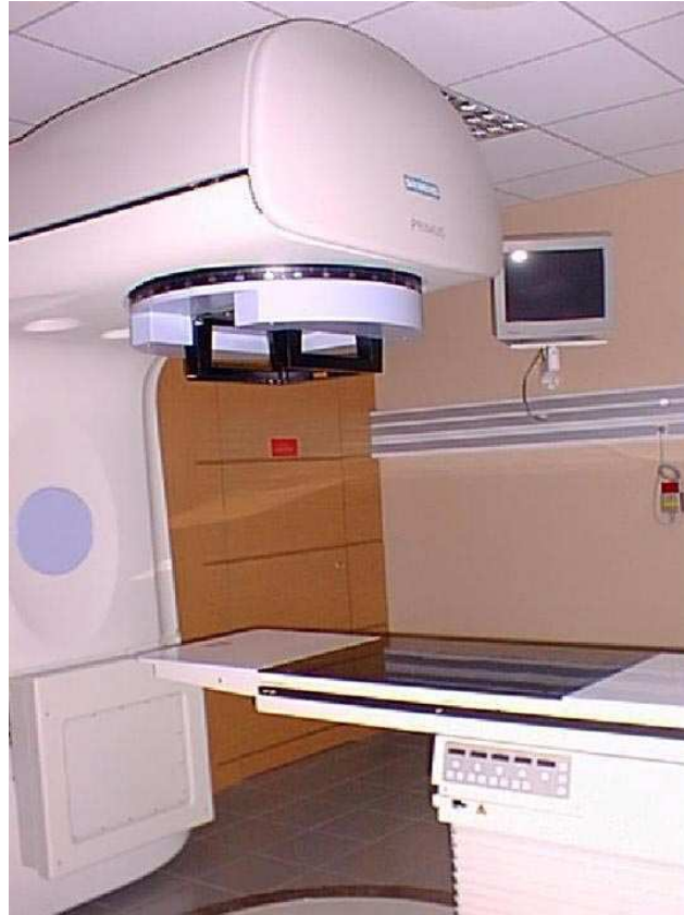
FIG. 1.1 – Accélérateur linéaire pour la radiothérapie de conformation avec modulation d'intensité. Image provenant de [Bondiau 2004].
