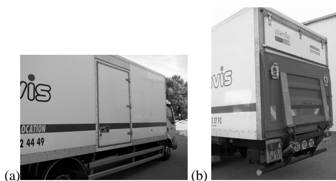
FIG. 6.2 – Détails de la remorque : (a) porte latérale de la remorque et (b) hayon hydraulique à l'arrière.
