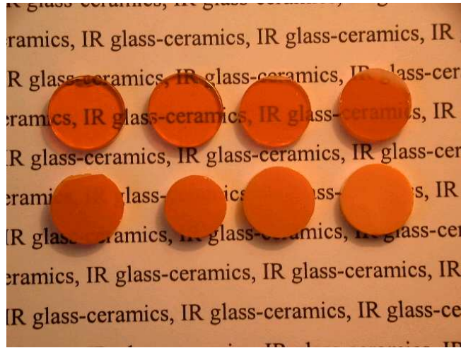
Fig. II.21. Vitrocéramiques obtenues par recuit du verre 62,5\text{GeS}_2-12,5\text{Sb}_2\text{S}_3-25\text{CsCl} à 290^\circ\text{C} selon différentes durées
