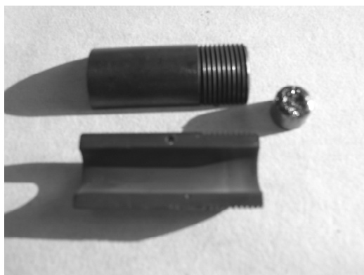
Fig. III.13. Photo du moule cylindrique et du verre coulé
