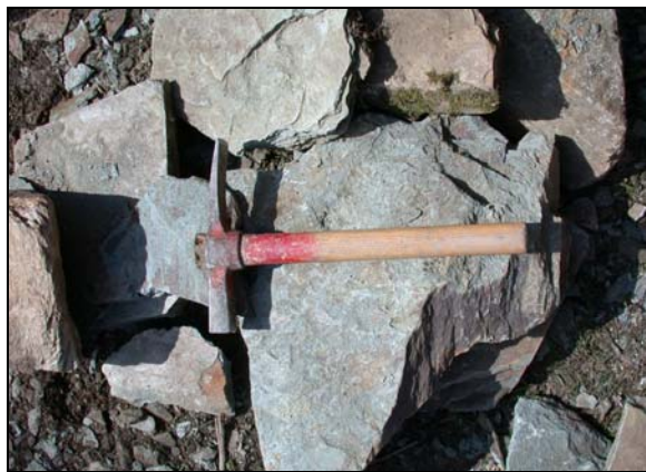
Figure 409 : Marteline utilisée pour retoucher les faces des dalles et des lauzes en schiste (Poids : 0,5 kg)
