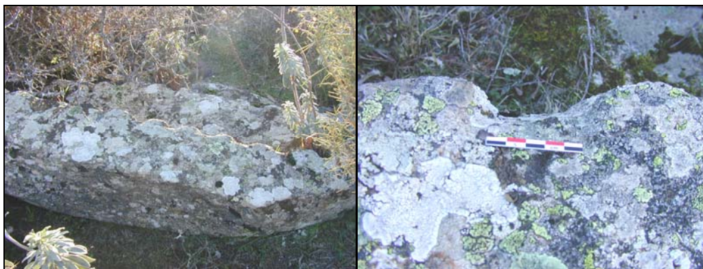
Figure 415 : Traces des encoignures laissées sur la roche suite à son débitage et détail d'une encoignure (Extraction contemporaine, Albertacce, Niolu)
