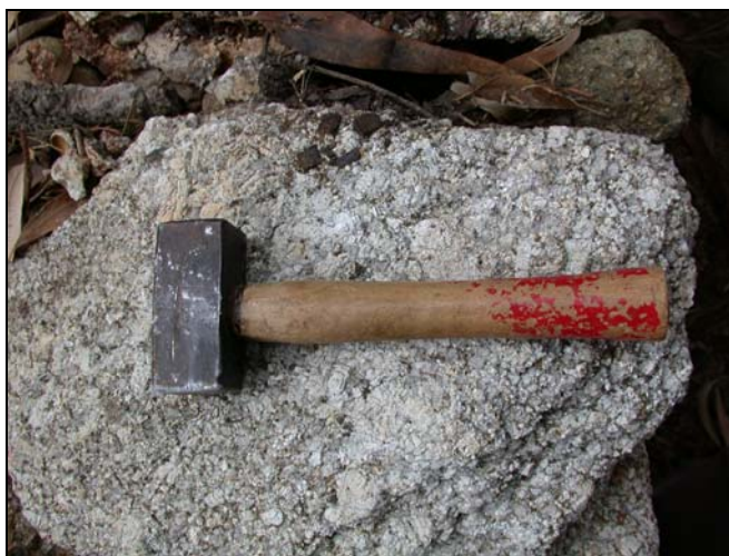
Figure 408 : Massette utilisée pour retoucher les faces des moellons en granite (Poids : 1 kg)
