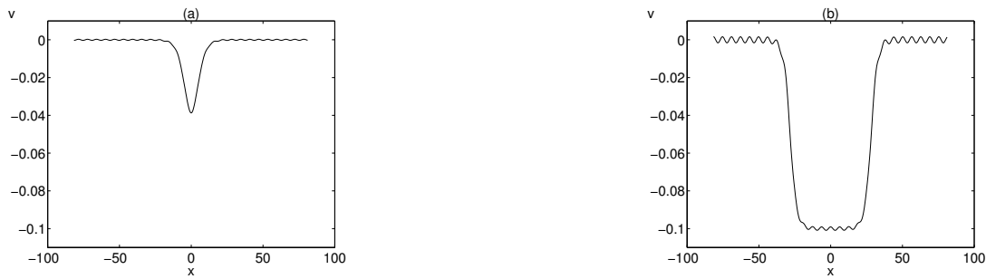
FIG. 5 – Exemples d’ondes solitaires généralisées, solutions de l’équation stationnaire forcée. Le forçage est : (a) u_s^1 , (b) u_s^2 .
