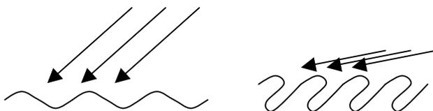
**Figure II-5** Topographie des surfaces obtenues par évaporation de SiO sous incidence
