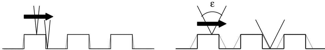
Criticité du choix de la pointe AFM dans le cas du contrôle de la topographie d'un réseau à bords verticaux. L'image résulte de la convolution du profil du réseau par la forme de la pointe.
