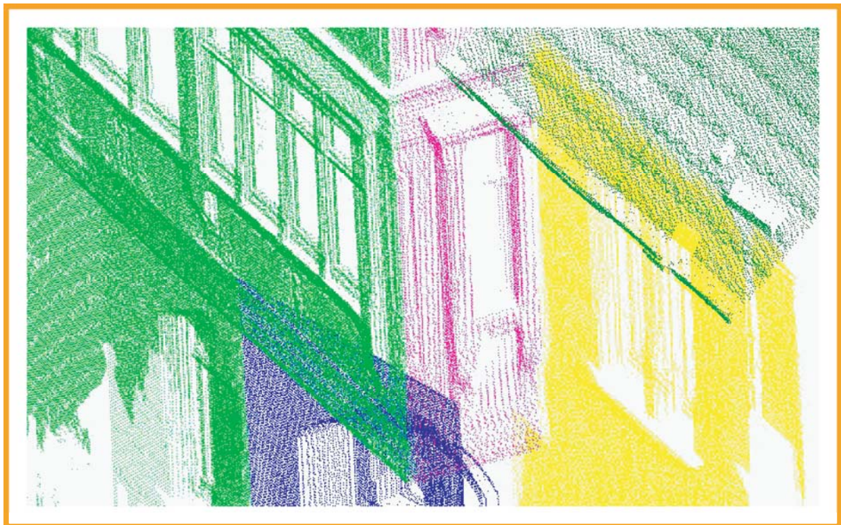
Figure 22 : segmentation d'un nuage de points
