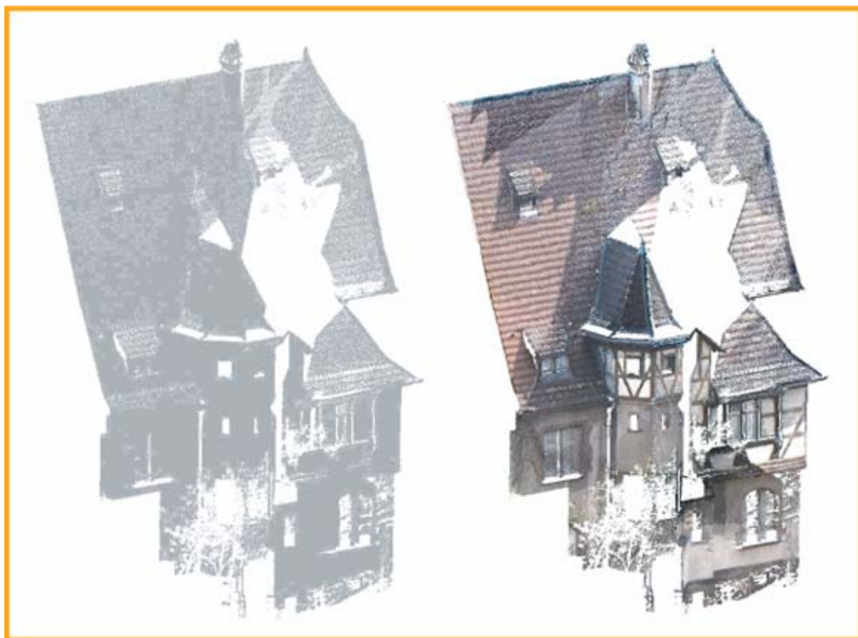
Figure 24 : nuage de points avec et sans les couleurs de l'objet
