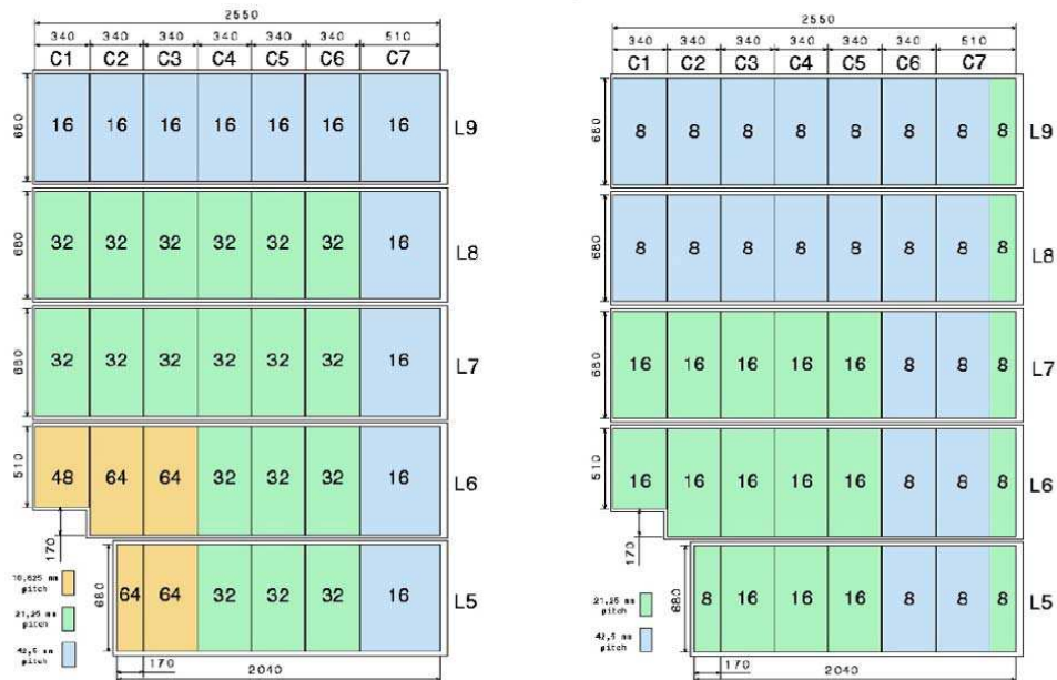
FIG. 2.21 – Segmentation en « strips » X (à gauche) et « strips » Y (à droite) pour un quart de plan de MT11. Le reste du plan se déduit par symétrie.
