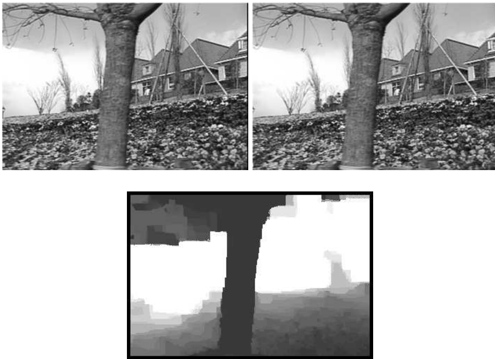
FIGURE 4.13: En haut, deux images consécutives extraites de la séquence Flower Garden. Puis, l'estimation des profondeurs par la Belief Propagation (100 itérations) en utilisant le mouvement de la caméra entre les deux images estimé par la méthode du chapitre 3.
