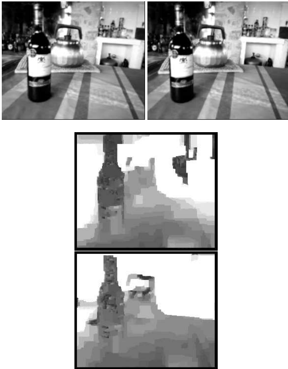
FIGURE 4.17: En haut, les deux images consécutives à partir desquelles on estime les profondeurs. Au milieu, l'estimation des profondeurs par la Belief Propagation (100 itérations) en utilisant seulement le mouvement de la caméra estimé. En bas, le résultat obtenu pour 15 itérations de l'algorithme présenté sur la figure (4.16) (avec chaque fois 100 itérations de la Belief Propagation). Les normes L^1 moyennes des différences entre l'image f et l'image g recalée sur f avec le mouvement et les profondeurs estimées sont respectivement égales à 7.07 pour l'image des profondeurs du milieu et 5.03 pour l'image du bas.
