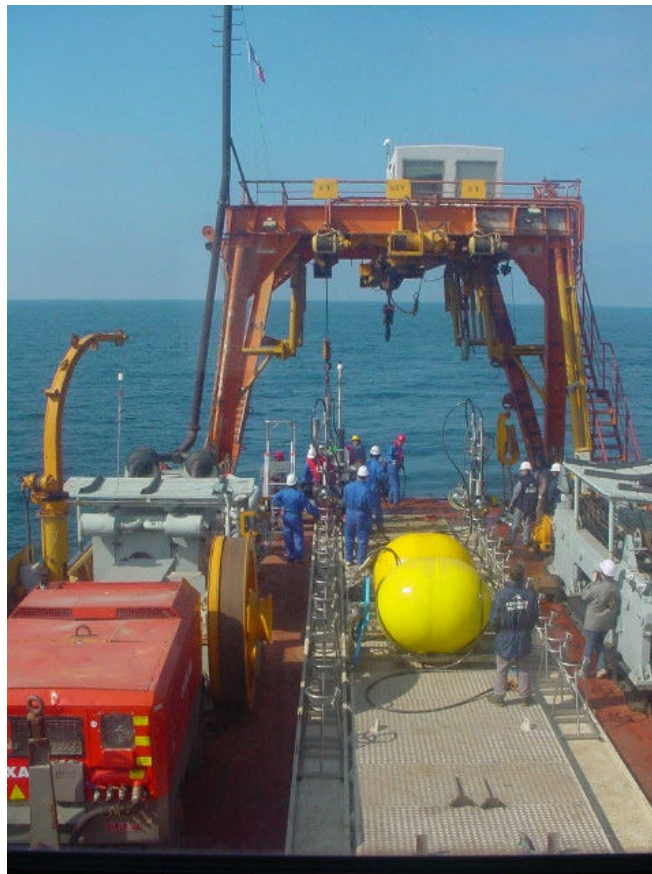
Figure 2-1 : déploiement de la ligne MILOM depuis le navire CASTOR, le 18 Mars 2005. Les deux grandes 'boules' jaunes que l'on peut distinguer sont les bouées de la ligne, assurant son maintien vertical sous l'eau. Au fond à gauche on peut deviner le BSS, 'l'ancre de la ligne', en train d'être mis à l'eau.
