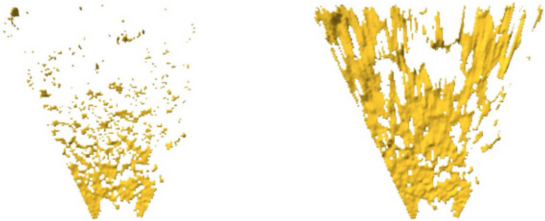
FIG. 4.11 – Influence de l'interpolation pour le remplissage d'une carte d'élévation : la carte de gauche est construite sans interpolation.
