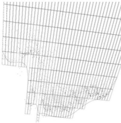
FIG. 4.21 – Extraction d'amers sur la base de la densité des points 3-D : des contours polygonaux, correspondant aux zones les plus verticales de l'environnement, peuvent être extraits sur la seule base d'images de points 3-D et fournir la base d'un recalage.
