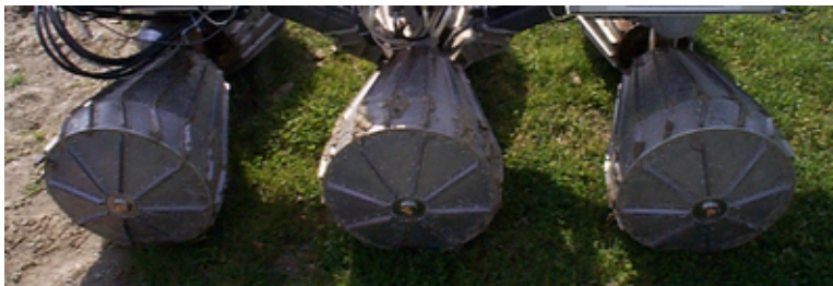
FIG. 2.3 – Conception des roues du châssis de Lama : les ailettes destinées à améliorer la traction sont orientées de façon à limiter les contraintes exercées par le sol au cours des rotations.
