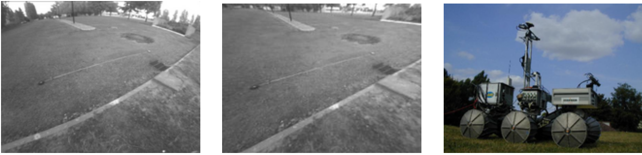
FIG. A.6 – Une image brute du banc stéréoscopique du bas, et après correction de la distorsion (au centre). Le champ de vue est représenté sur la figure de droite.
