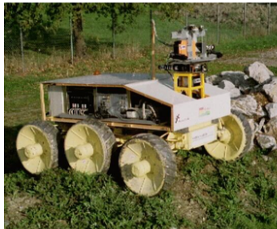
FIG. 1.2 – Le robot Adam. Utilisé au LAAS de 1992 à 1996, sa couche de locomotion a été développée par Matra Marconi Space. Le seul moyen d'acquérir des données sur son environnement était un télémètre laser associé à un système de déflexion suivant deux axes.
