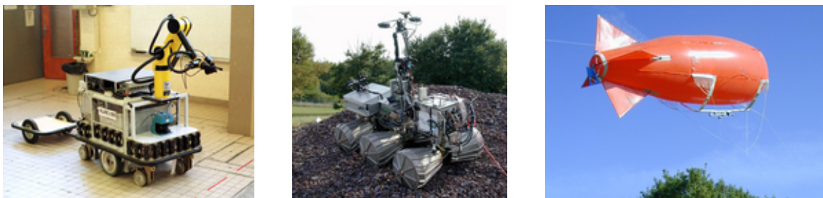
FIG. 5.3 – Robots ayant des configurations géométriques particulièrement différentes (de gauche à droite, Hilare IIbis, Lama et Obelix) : leur point commun est qu'ils peuvent tous se décrire grâce à un graphe où les nœuds représentent des repères particuliers (capteurs, actionneurs ou articulations). Les branches connectant les nœuds correspondent alors soit à une partie rigide du châssis, soit à une configuration d'un actionneur.
