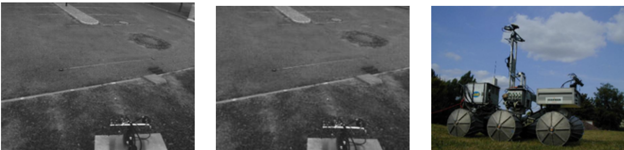
FIG. A.7 – Vue de la même scène que la figure A.6 par le banc du haut - on distingue le second banc dans le bas de l'image. La correction de la distorsion est à peine perceptible, mais reste nécessaire lors de la rectification des images.
