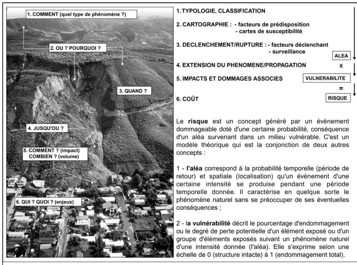
Figure AP.2 : Les différentes composantes du risque illustrées par le glissement de La Conchita, Californie, Etats-Unis, modifiée de Leroi (1996) et Malet (2003). Les notions de risque, aléa et vulnérabilité sont définies par Varnes (1978).
