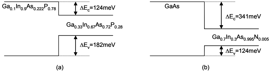
Figure 1-2 : Décalages de bandes pour deux exemples de structures, (a) structure conventionnelle InGaAsP/InP et (b) structure InGaAsN/GaAs.
