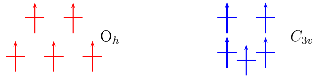
FIG. 7.13: Schéma du remplissage des niveaux 3d de \text{Fe}^{3+} .
