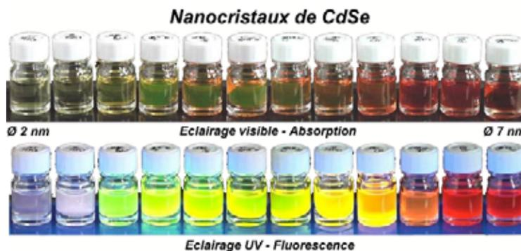
**Figure II-21** Dépendance des propriétés optiques (absorption en haut et fluorescence en bas) de la taille des nanocristaux à l'exemple de nanocristaux cœur de CdSe entre 2 et 7 nm
