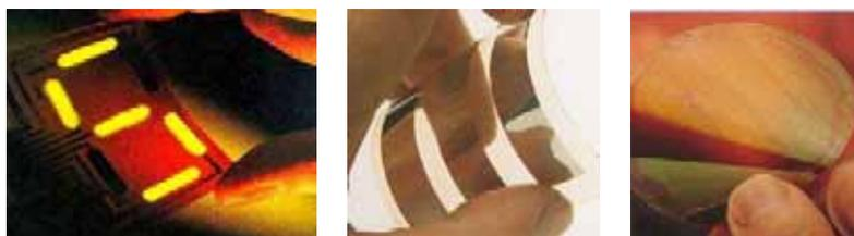
**Figure II-13** Dispositifs électroniques ou optoélectroniques à base de polymères conjugués : diodes électroluminescentes, cellules photovoltaïques et transistors à effet de champ (de gauche à droite).
