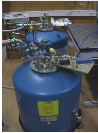
FIG. 6.4 – Photographie des deux oscillateurs cryogéniques.
