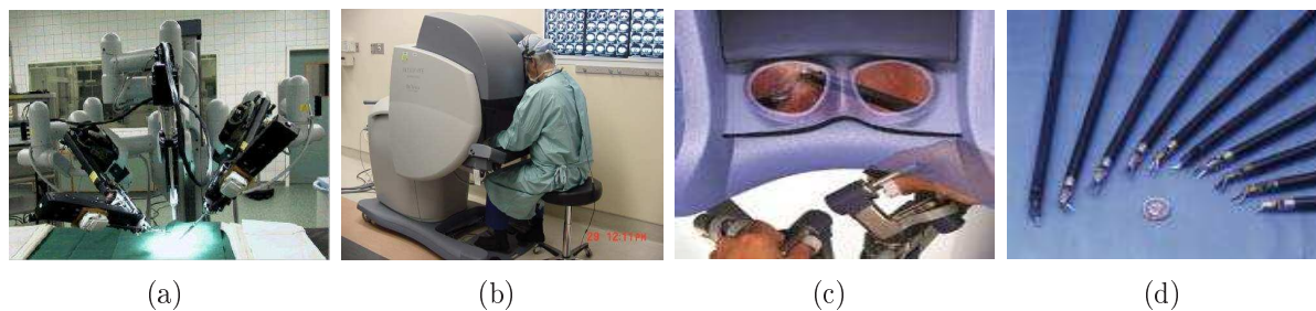
FIG. 1.6: Robot télé-opéré Da Vinci™ : (a) robot esclave composé de trois bras articulés (deux bras pour manipuler les instruments, et un bras pour porter l'endoscope), (b) console maître, (c) détail de la console maître et de la prise en main vue du chirurgien, (d) collection d'instruments EndoWrist™.
