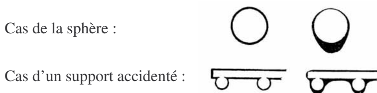
Figure 13 : Incidence du type de peinture sur la régularité du film de peinture par application de peinture poudre (à gauche) et de peinture liquide (à droite). (Source : GOTS n°720(24))
