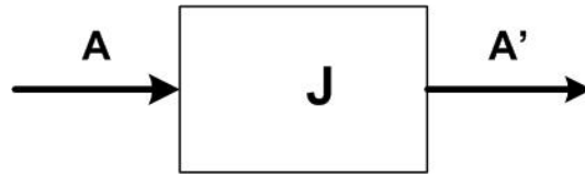
FIG. 2.12 – Matrice de Jones comme relations entrée-sortie d'un composant optique
