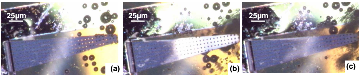
Figure 2 : Photos d'une poutre hexagonale actionnée électrostatiquement dans de l'eau. a) Première apparition de bulles pour une tension de 2V. b) Augmentation de la tension à 4V, la cinétique de l'électrolyse s'accélère entraînant la partie mobile de l'actionneur. c) A 6V la structure se tord sous l'effet de la force exercée par le dégagement gazeux.
