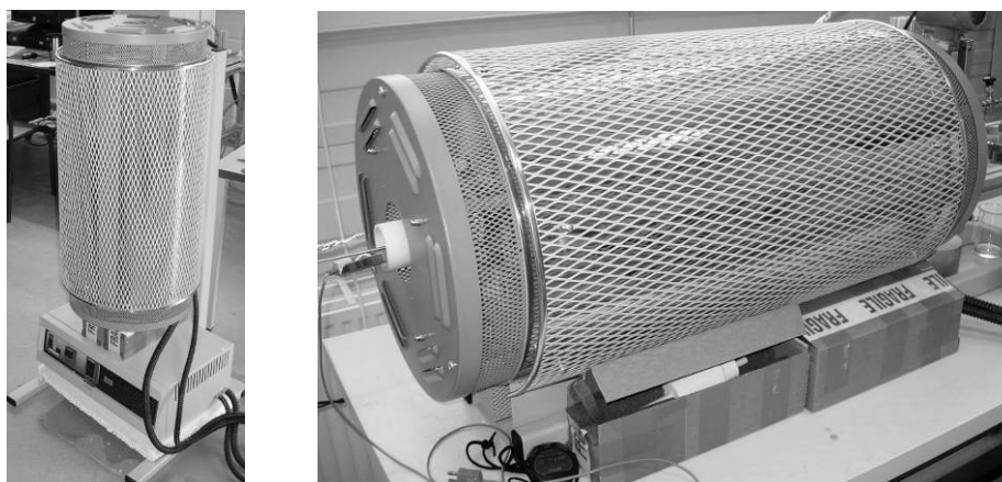
Figure 50. Four de pyrolyse Carbolite sous deux configurations possibles : verticale (à gauche) et horizontale (à droite, comme utilisé pour le banc d'essai).
