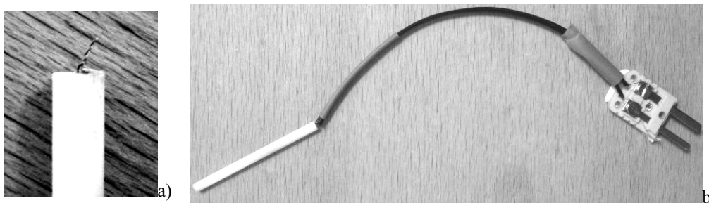
Figure 159. (a) Fils torsadés (b) Thermocouple composé d'une fiche subminiature jaune, de gaine Téflon noire pour l'isolation de chaque fil et d'un tube blanc à deux trous en céramique haute température.
