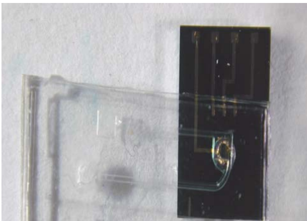
Figure 2.76 : Photo d'une microcuve en PDMS reporté sur un capteur pH-ISFET
