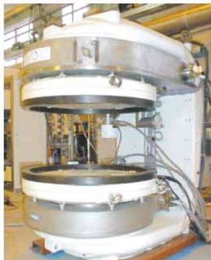
Figure 11 : Prototype d'un IRM ouvert utilisant les matériaux supraconducteur à haute température critique (fils au Bi2223).
