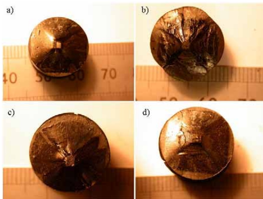
Figure 77 : Disques de Y123 obtenus par infiltration croissance, à partir de a) Y211 commerciale, b) Y211 broyée, c) Y211 + 0.5% en poids Pt et d) Y211 broyée + 0.5% en poids de Pt.
