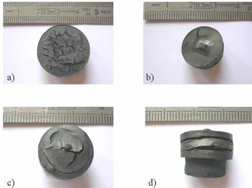
Figure 51 : Photographies d'échantillons Y123 fissurés obtenus par le procédé d'infiltration. Différents types de fissures ont pu être observés : a) multiples petites fissures en surface, b) une grosse fissure en surface qui empêche le domaine de croître, c) quelques grosses fissures en surface, d) très grosses fissures parallèles au plan (\vec{a}, \vec{b}) .
