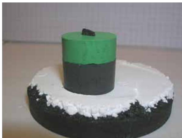
Figure 43 : Photographie d'un échantillon avant le traitement thermique d'infiltration et croissance (montage « - »).
