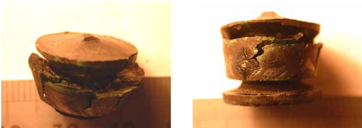
Figure 61 : photographie d'un échantillon dont le disque de phase verte a été mise en forme sous très haute pression (500 MPa).
