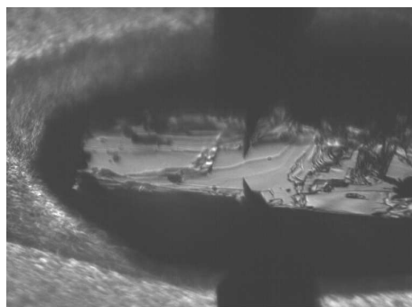
Fig 4.13: Photo d'un échantillon de bronze bleu bien clivé, logé dans la tête STM. Il présente de larges terrasses optiques. Diamètre de la zone totale clivée: 2mm.
